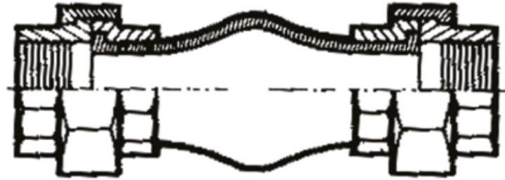
Giunto elastico compensatore antivibrante di gomma filettato EPDM PN16 - DN3/4"-3".
