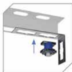
Installazione aerea con una mano sola
